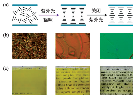
图 2 (a)胆甾相液晶复合材料的光驱动取向原理示意图与对应不同状态的 (b)POM 照片和 (c)实物图
